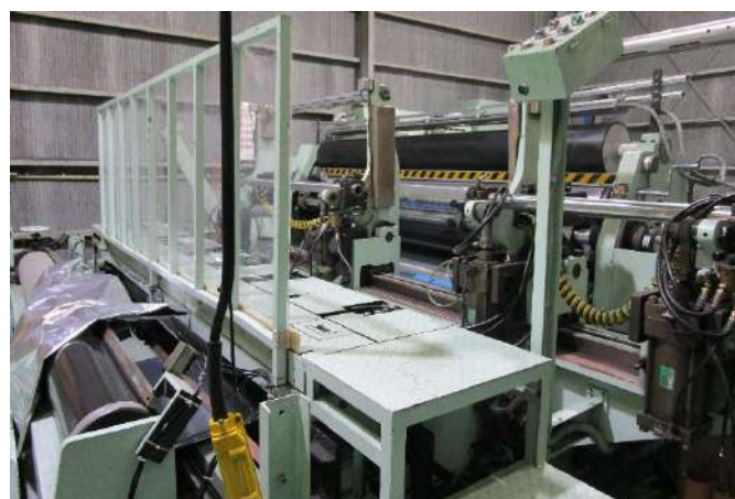
▲縦 2500mm のフィルムに対応できる巨大機械
