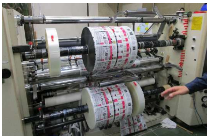
▲フィルムを切断して巻き取る機械
