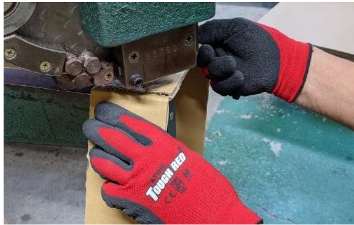
▲「ステッチャー」という機械でダンボールを繋ぎとめる様子
