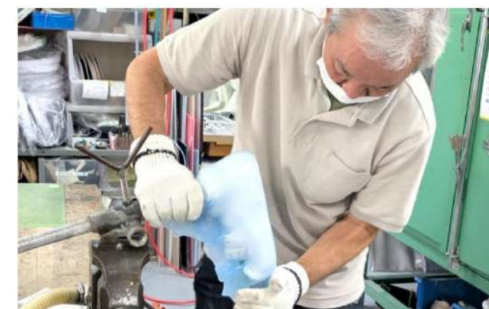
▲高温の柔らかいプラスチックを石膏の雄型に巻き付け吸引する様子。
